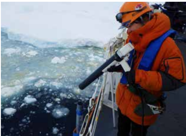
図4 トッテン氷河沖にて世界初の集中的な観測に参加「しらせ」船上から海へXCTDセンサーを投下。
